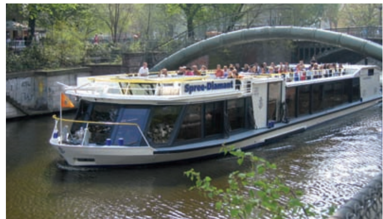
Obwohl die Umweltzone nicht für Fahrgastschiffe gilt, hat die Reederei Riedel ihre „Spree-Diamant“ mit einem hochwirksamen Rußfilter ausgestattet
