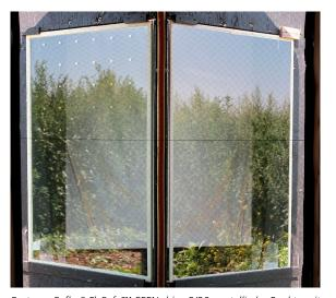
Eastman Saflex<sup>®</sup> FlySafe<sup>™</sup> SEEN shiny 9/90: metallische Punkte mit 9 mm Durchmesser im Abstand von 90 mm: hoch wirksam und wegen der hohen Reflektanz auch für Position 2 geeignet (links Prüf-, rechts Referenzscheibe).
